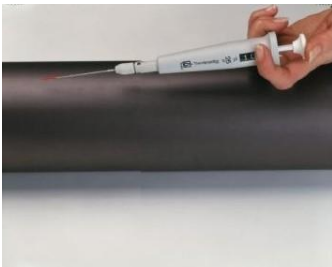
Paso 1: Se aplica una determinada cantidad de tinta con la micropipeta
