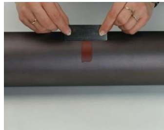
Paso 2: Se emplea una rasqueta para diseminar la tinta sobre el cilindro anilox
