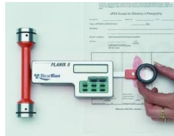
Paso 3: La tinta diseminada es transferida a una hoja de papel. Si se usa un planímetro, se mide el área de extensión de la tinta sobre la hoja de papel. Si se usa un software, la hoja de papel se digitaliza y la imagen digital es transferida al software el cual realiza la medición en forma automática.
