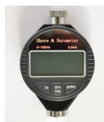
Durómetro digital portátil Shore A
