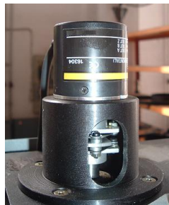
Celda de carga de alta precisión: 1 unidad Celda de carga plana de 5 kN, para tracción y compresión
