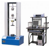
Aparato de ensayos universales
