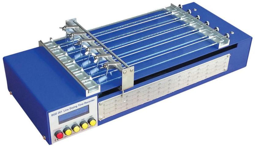
Las etapas del tiempo de secado pueden evaluarse con facilidad con la escala de graduación según la configuración de la velocidad de recorrido. En la pantalla se puede observar el tiempo total de cada ensayo.
