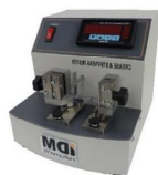
Probador de plisado y rigidez de cajas
