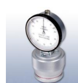
Durómetro Shore A
