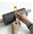
Cintas volumétricas Para medir el volumen de descarga de tinta de un cilindro grabado
